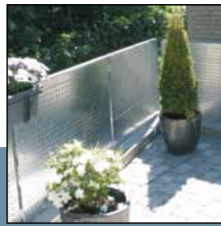
Recinzione in lamiera forata zincata con foro quadro da 9 mm, passo 34 mm, per una terrazza.
